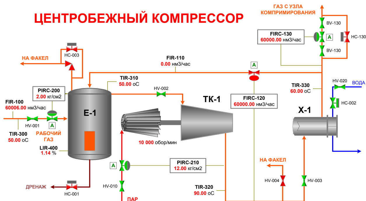
Рис. 3. Схема узла компримирования
